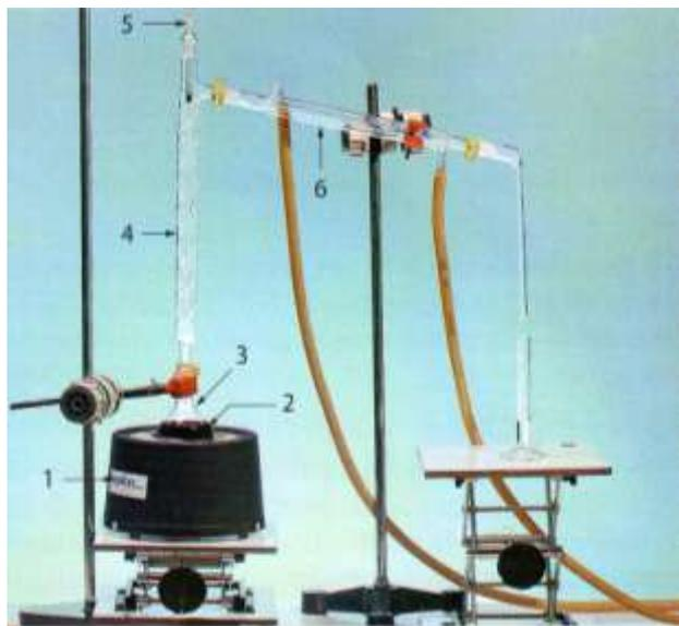
**Montage de distillation fractionnée** (ci-contre).
